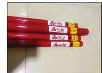
ไม้ทดสอบอุปกรณ์ (Telescopic Access Poles)
